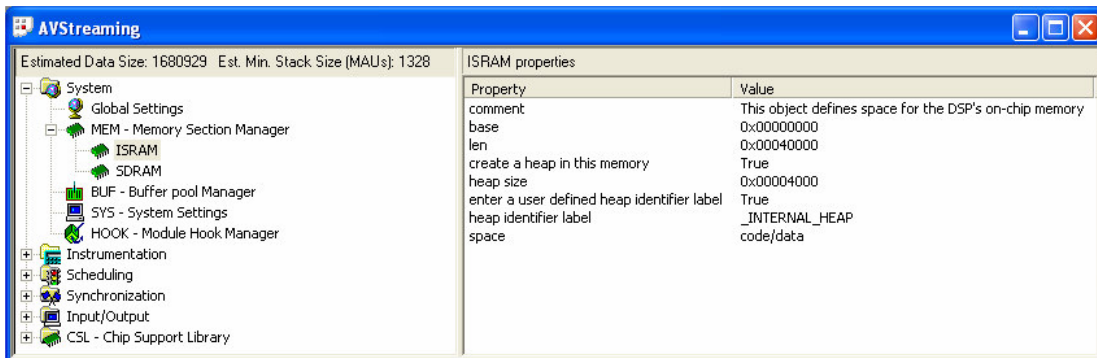
Slika 7.1: ISRAM segment MEM modula
