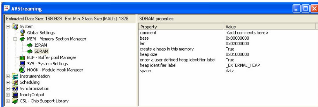
Slika 7.2: SDRAM segment MEM modula
