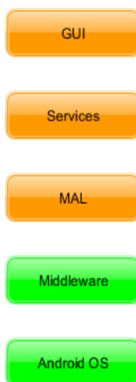
Slika 3: Struktura programske podrške DTT prijemnika zasnovanom na Android platformi
