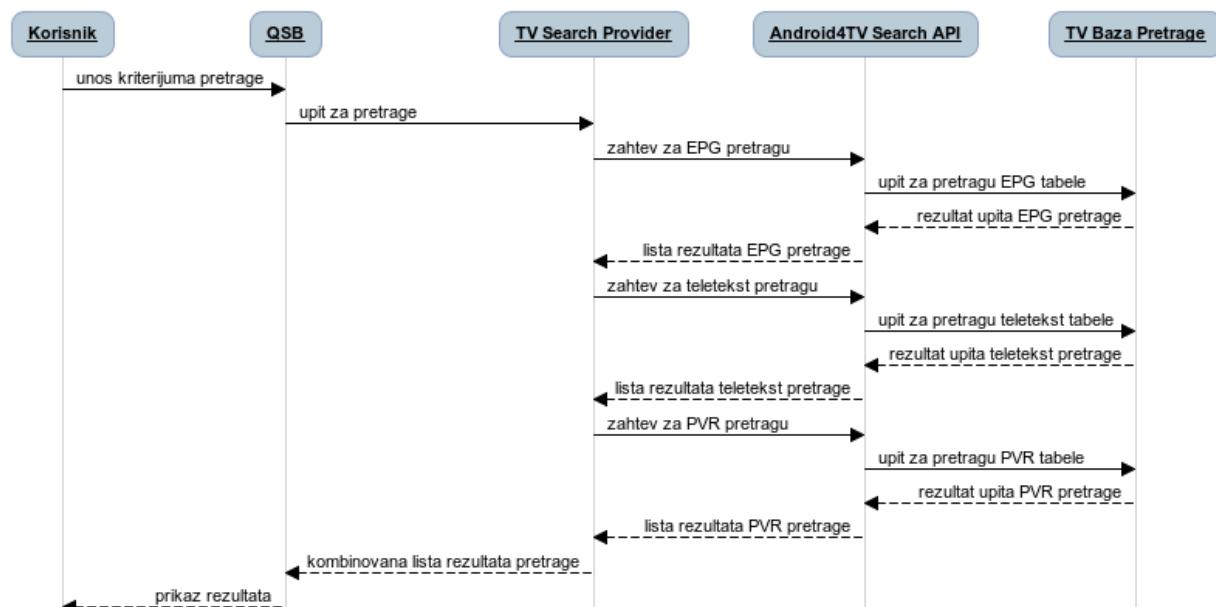
Slika 5.11 Sekvenčni dijagram obrađivanja zahteva za pretragu
