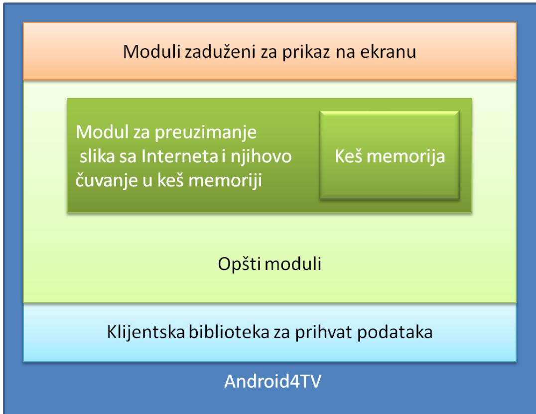
Slika 4.1 Prikaz modula za preuzimanje slika i keš memorije unutar celog sistema
