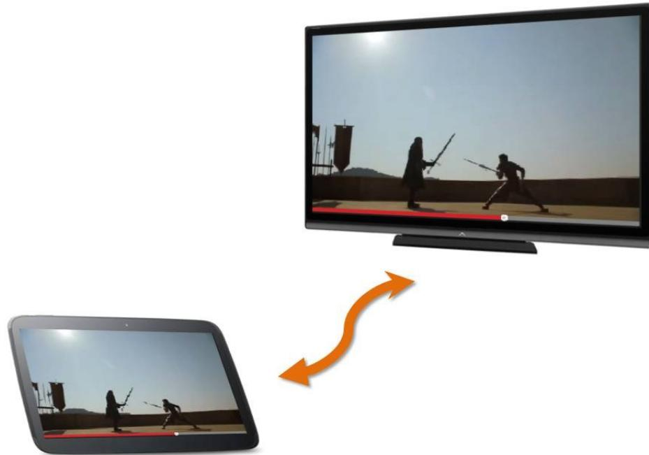
Slika 1.1 Prenos sadržaja sa „drugog ekrana“ na centralni uređaj
