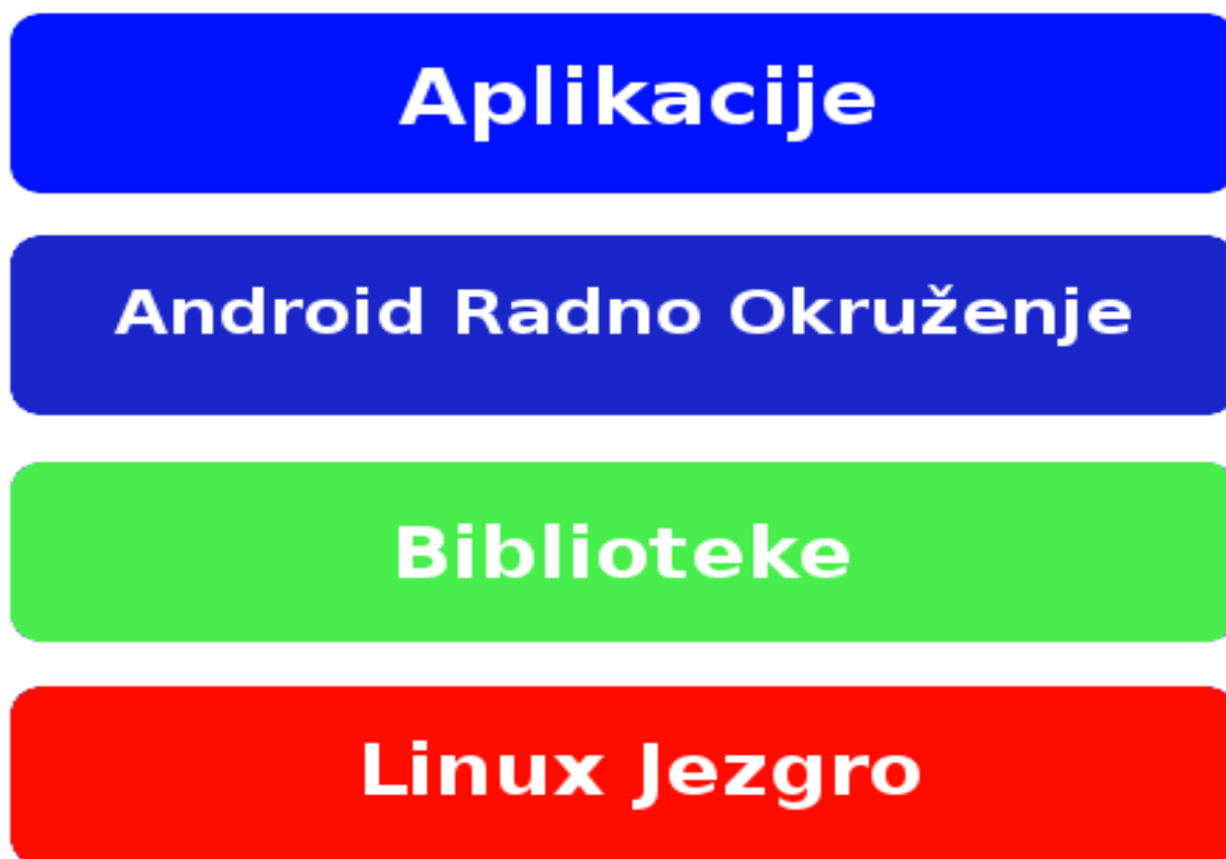
Slika 2.1 Arhitektura Android platforme
