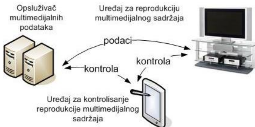
Slika 2.4 Komunikacija DMS, DMC, DMR uređaja
