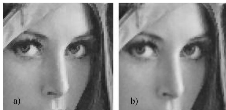
Slika 15 - Detalj testne slike interpolirane AISLED metodom pre (a) i nakon (b) unapređenja
