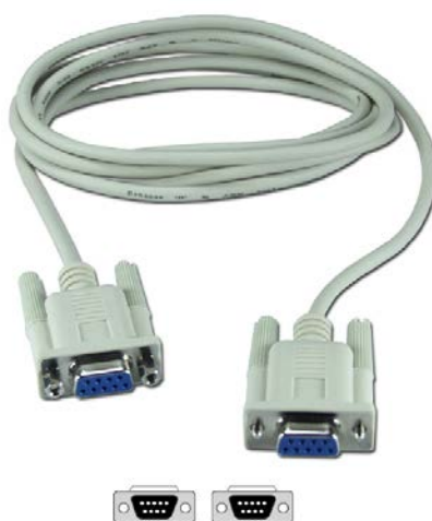
Slika 6.1 Deveto-pinski žensko-ženski konektor korošćen za povezivanje osciloskopa i računara
