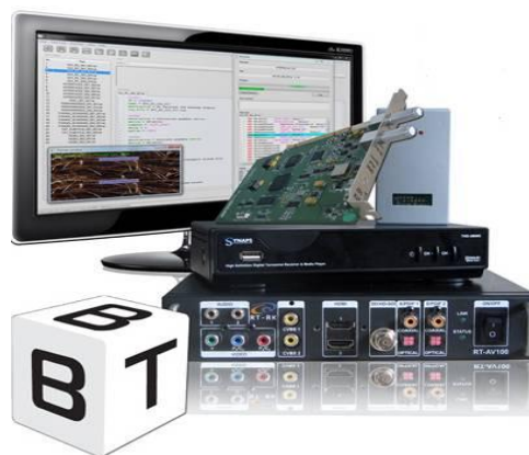
Slika 4.1 BBT sistem za automatsko testiranje sa osnovnim uređajima
