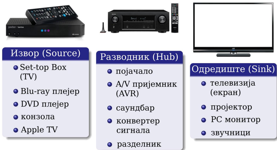
Слика 2.1 Основни елементи кућног A/V система [3]
