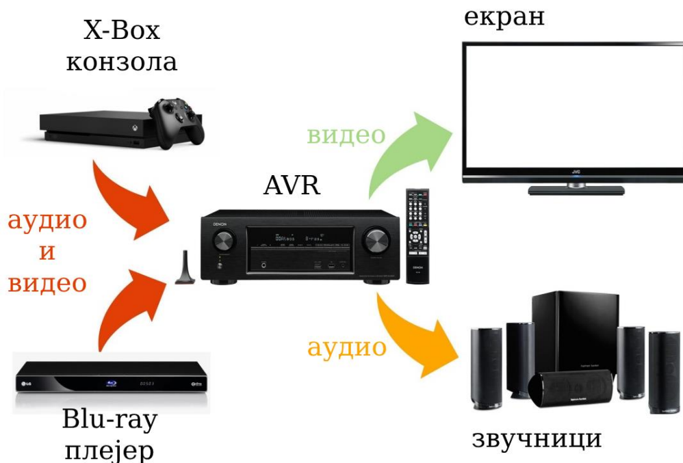
Слика 2.5 Типични систем кућног биоскопа [3]
