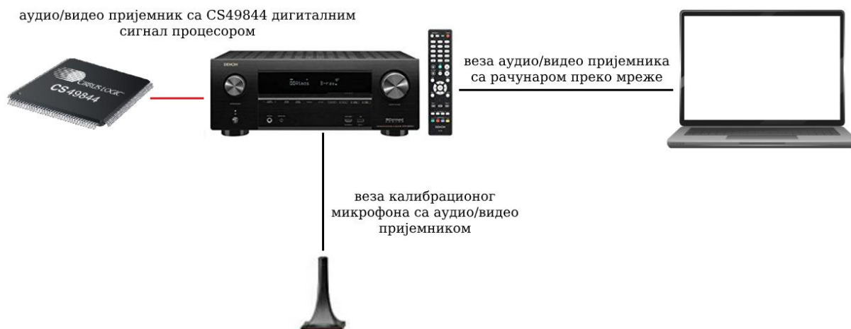
Слика 1.1 Пример поставке система за калибрацију
