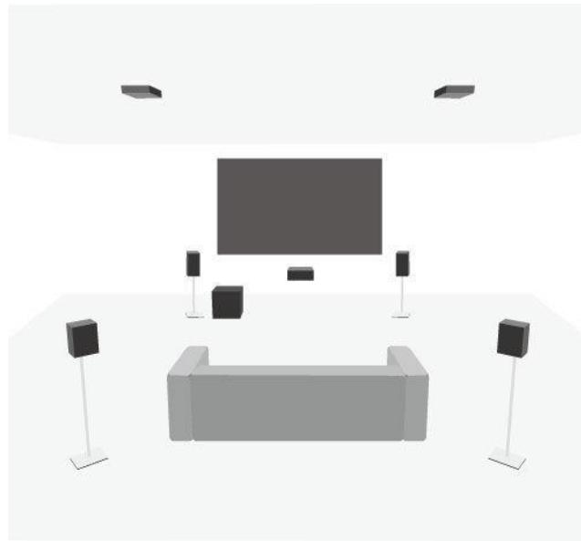
Slika 2.2 Audio sistem sa 5.1.2 konfiguracijom zvučnika
