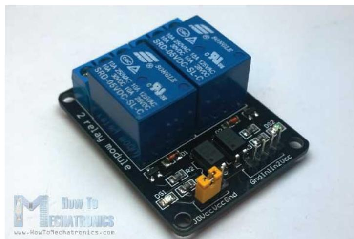
Slika 3.5 Arduino relejna ploča
