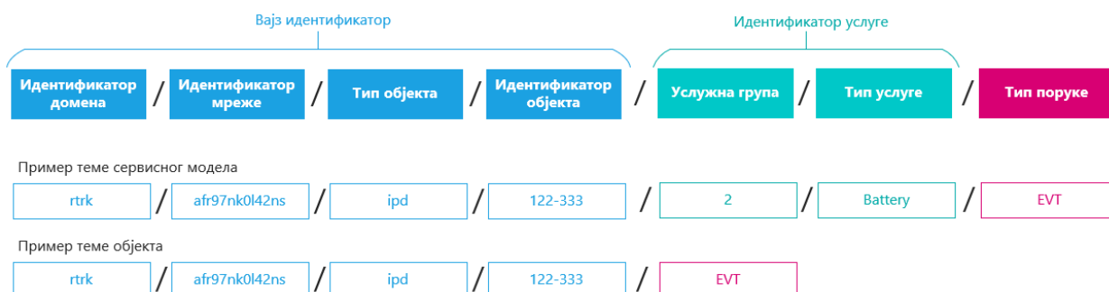
Слика 20 Пример теме уређаја који са контролером комуницира преко уређаја за конверзију протокола
