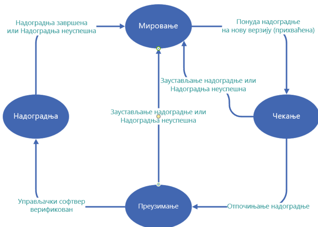
Слика 24 Дијаграм стања уређаја током процеса надоградње управљачког софтвера
