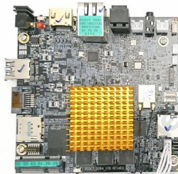
Слика 10: STB развојна плоча Synaptics BG5CT
