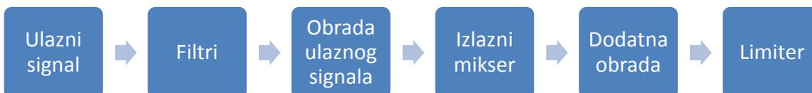
Slika 2.5 Pozicija limitera jednom primeru obrade audio signala
