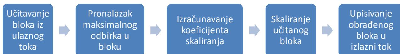
Slika 3.1 Blok dijagram algoritma
