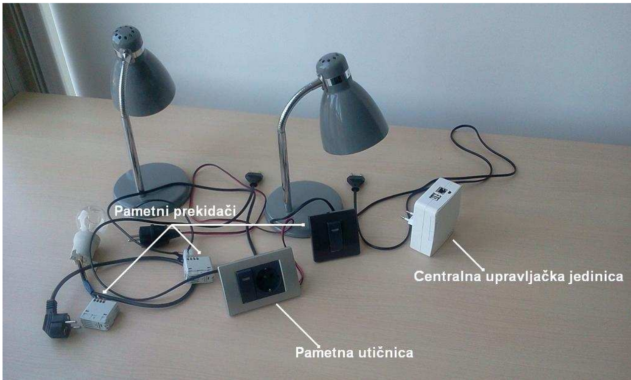
Slika 10. OBLO infrastruktura: pametni prekidači za osvetljenje, pametna utičnica i centralna upravljačka jedinica za agregaciju i obradu odbiraka snage radio signala.
