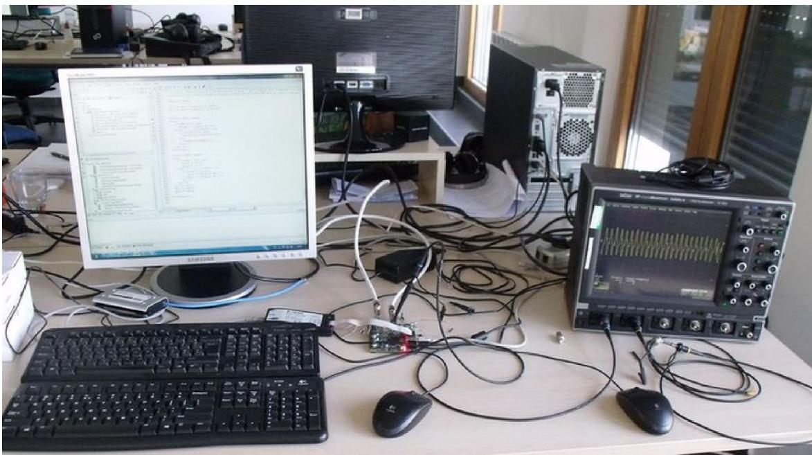
Slika 3.1 Verifikacija fizičke arhitekture (na slici: verifikovanje rada modulatora)
