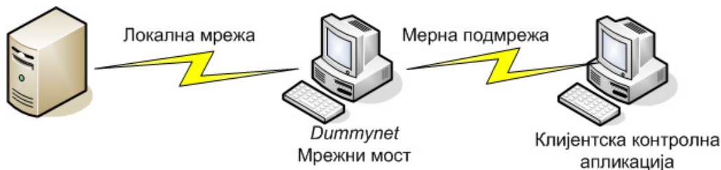
Слика 16 - окружење за мерење понашања система код постојања грешака на комуникационом каналу
