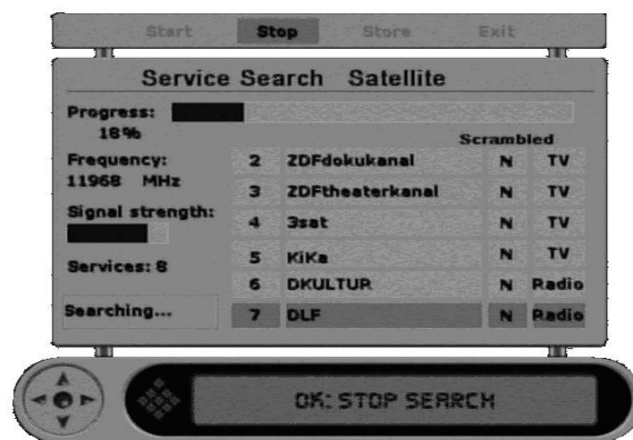
Sl. 3. Aplikacija za automatsku pretragu frekventnog opsega koja se izvršava na MICTOS
