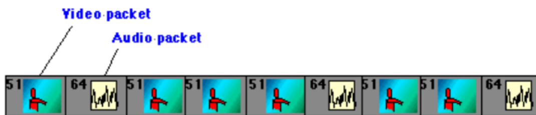
Слика 2.5 Мултиплексирани аудио и видео PES пакети једног програма [4]
