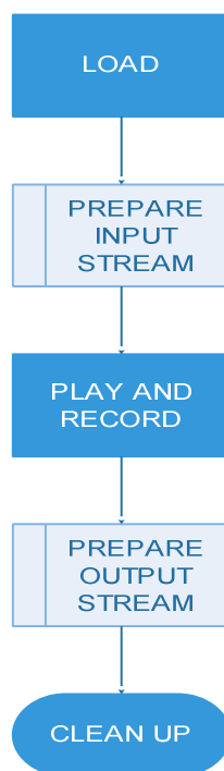
Slika 4.7 – Blok dijagram jednog BBT testa
