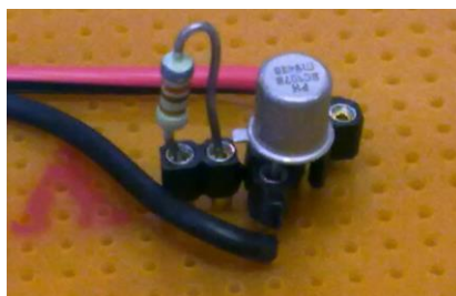
Slika 24 - Spoljašnje kolo za prilagođavanje naponskih nivooa
